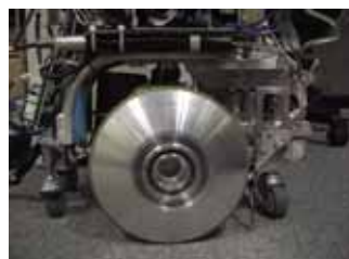
動的に補助輪を切り替えられる 同軸2輪倒立振り子移動機構
